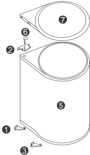
1- Fijar con tornillos el enganche inferior (1), enganche superior (2) y el enganche inferior (3) con tornillos.
