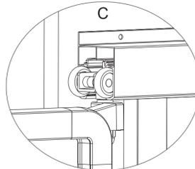
10. Encajar los carros con las guías superior e inferior para que el espejo se deslice.(C y D). Ver imagen 6.
