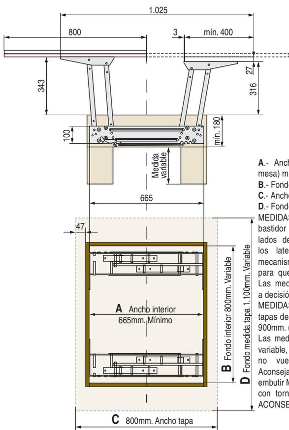
**EJEMPLO MESA DE 800x1100:** Detalle fijación de los mecanismos a los dos lados del bastidor con unas medidas de interior de **A** Ancho 665mm. y **B** Fondo de 800mm.
