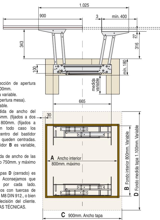
**EJEMPLO MESA DE 900x1100:** Detalle fijación de los mecanismos a los laterales del bastidor, con unas medidas de interior de **A** Ancho 800mm. y **B** Fondo de 800mm.
