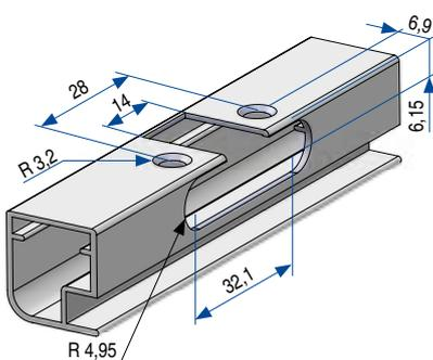
Gracias a sus dimensiones reducidas, las bisagras para perfil metálico permiten la utilización de perfiles con espesores y anchos reducidos. Los cristales se pueden colocar con juntas de gomas, garantizando así la falta de ruido, facilidad de montaje y rápida sustitución del cristal.
