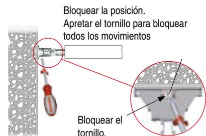
**TRIADE** Soporte de montaje oculto para estantes con espesor de 30 a 40mm.
