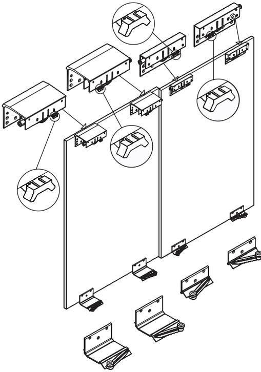
**STARLINE** es un sistema de deslizamiento para armarios de 2 o 3 puertas superpuestas. Para espesores desde 18mm. hasta 50mm. y con capacidad de hasta 100kg.
