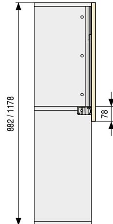
Ejemplo de colocación del herraje en un armario.
