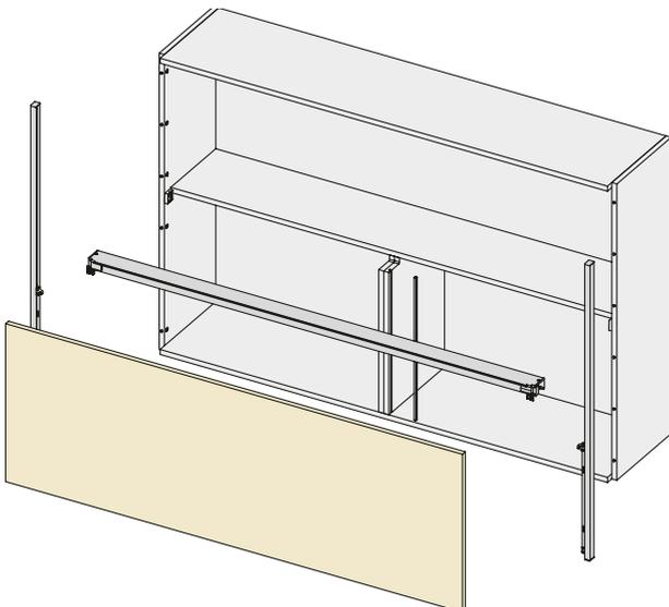
**MOVER FLAT** soporta diferentes tipos de puertas según el ancho de la misma, siempre teniendo en cuenta que la altura de la puerta deberá estar entre 480mm. y 628mm.:
