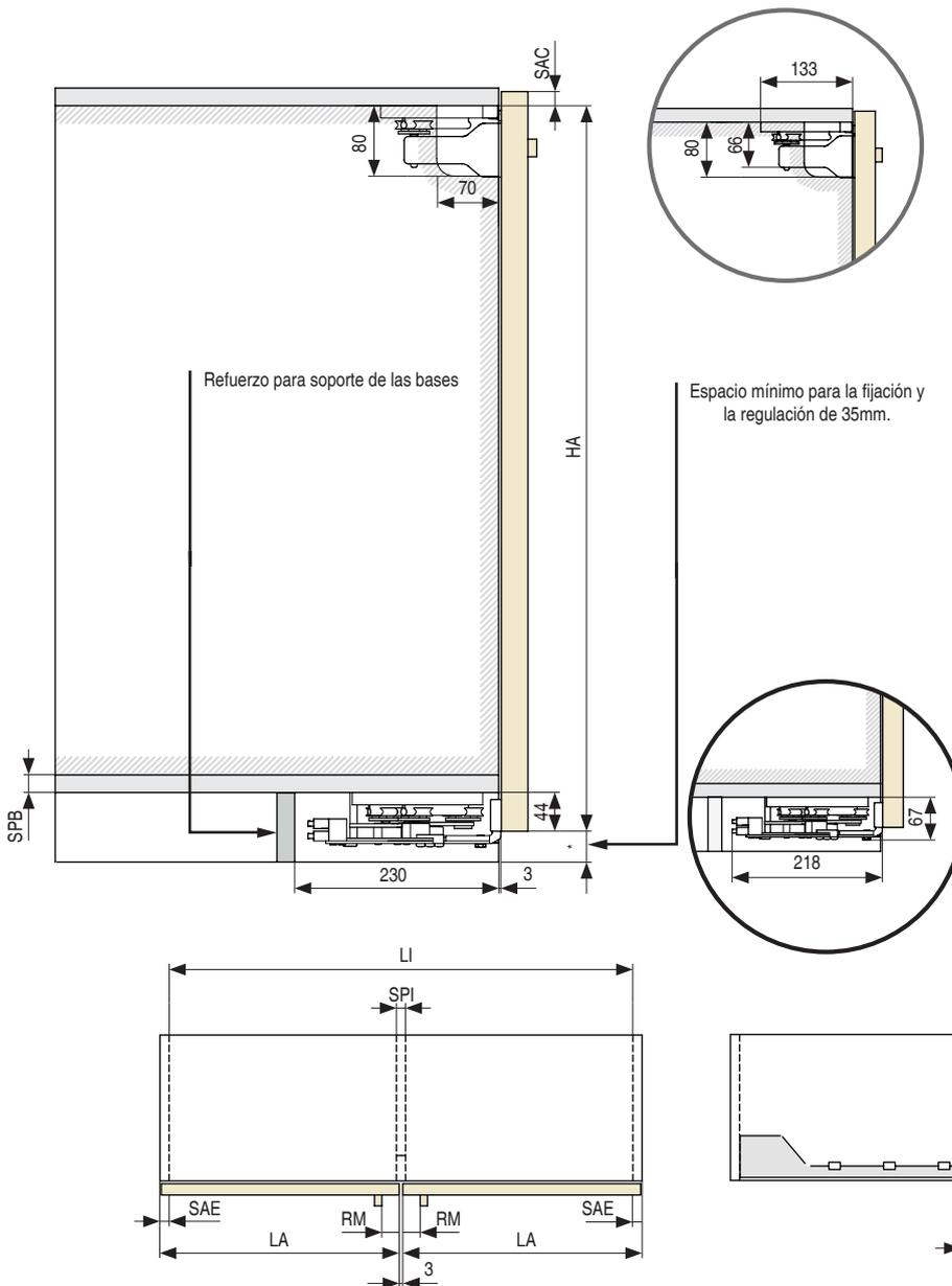
**S10 Bajo FLEX** es un sistema para muebles bajos de puertas coplanarias, tipo aparador, de pequeñas dimensiones con un peso máximo de 10kg.
