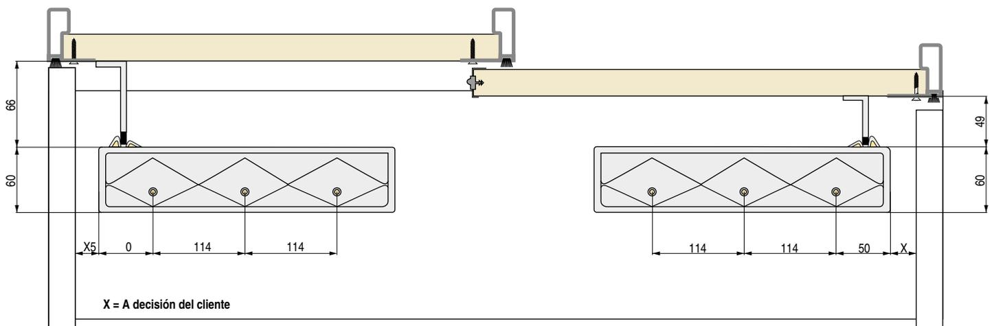
**ABANTOS 100** KIT CON 2 FRENOS DE CIERRE AMORTIGUADO
