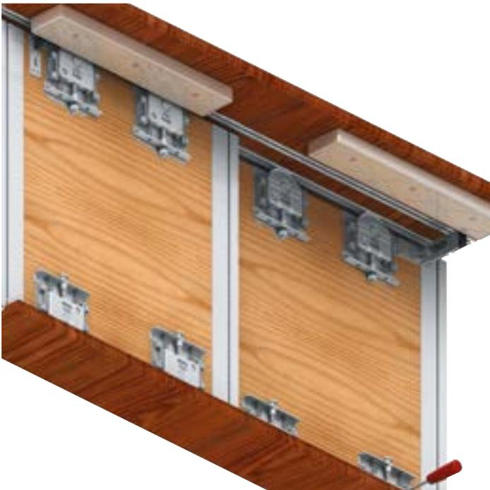
El sistema de frenos con cierre amortiguado **ABANTOS** es muy sencillo y fácil de montar. Sistema de cierre por medio de aire. Permite colocar el kit de frenos en cualquier tipo de armario, tanto de puertas correderas superpuestas como de puertas empotradas. Los frenos de cierre amortiguado se colocan en la parte interna superior del mueble y los topes de freno en las puertas.
