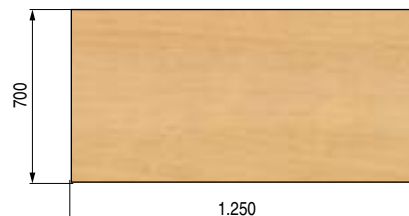
Dimensiones mínimas del tablero
