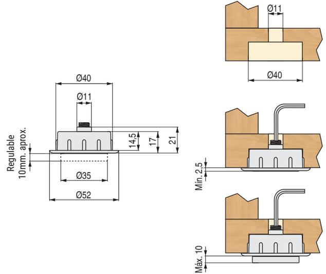
• Regulación por el interior del mueble, con llave allen de 4mm.
