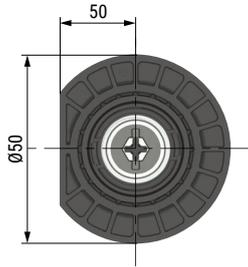
• Regulación por el interior del mueble, con llave allen de 6mm., destornillador plano o pozidriv.
