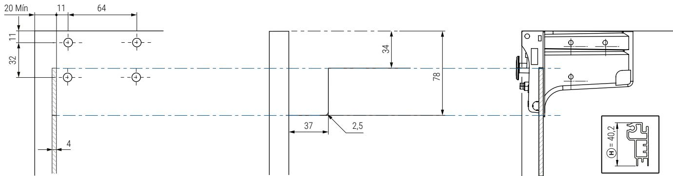
Taladrado con panel trasero de madera de 8 mm y barra de aluminio 40,2mm.
