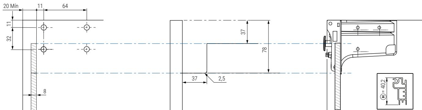
Taladrado con panel trasero de madera de 4 mm y barra de aluminio 80,5mm.
