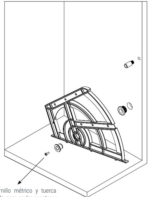
Con tornillo métrico y tuerca embutida para poder montar y desmontar fácilmente.
