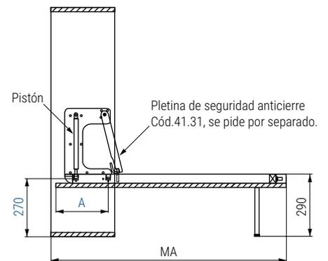
**Atención.** El somier de pata basculante precisa de un mecanizado especial en la puerta para asegurar la perfecta salida de las patas del somier.
