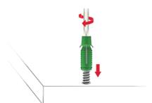
Perforar a Ø5mm. en la cara del otro panel.
