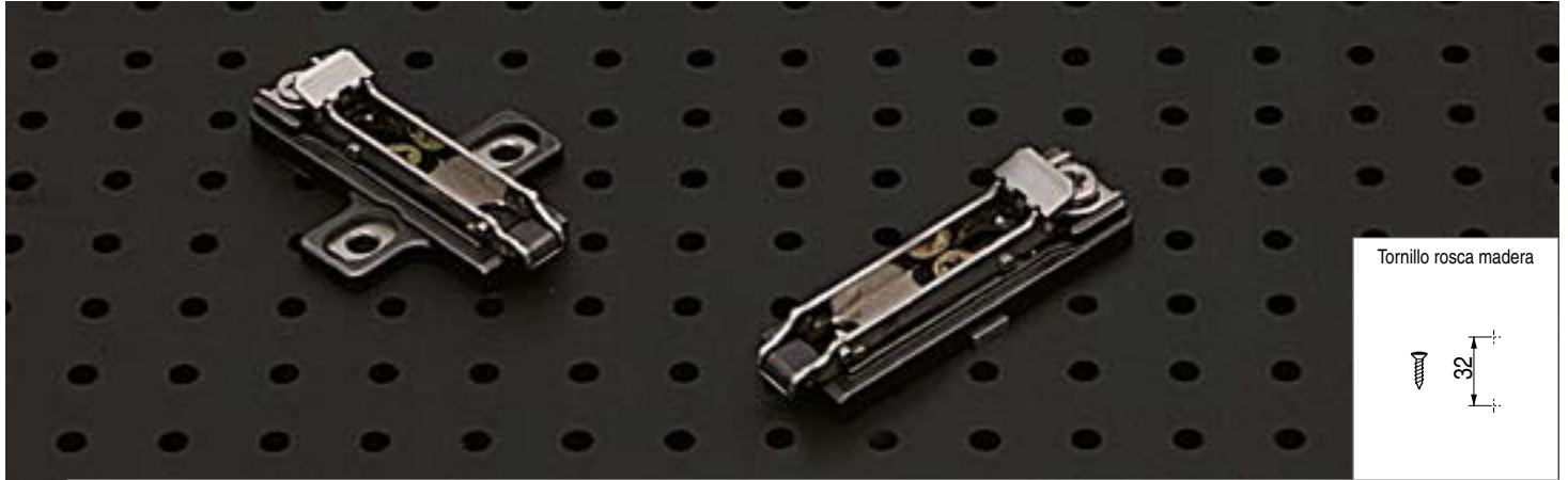
Base DOMI recta modelo BAP 3. Regulación frontal y vertical mediante excéntrica H3
