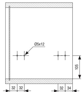
Instalación de mecanismo simple
