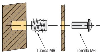
Para una mayor resistencia colocar Tuercas M6 de embutir de rosca madera con Tornillos de M6.
