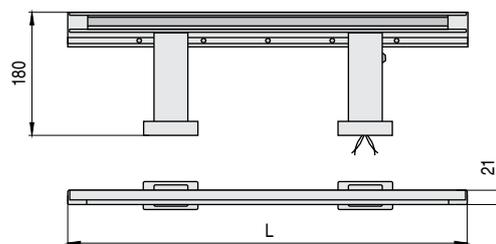
ECLISSI aplique para lámpara fluorescente lineal con difusión de la luz directa con iluminación decorativa o de cortésia nocturna, compuesta de LEDs de luz blanca. Estructura realizada en aluminio anodizado mate, con soportes a pared extruido en policarbonato transparente pintado en aluminio RAL 9006. Completa con interruptor unipolar y dos transformadores (para fluorescente y LEDs), instalados en uno de los brazos del aplique.
