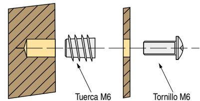
Para una mayor resistencia colocar Tuercas M6 de embutir de rosca madera con Tornillos de M6.
